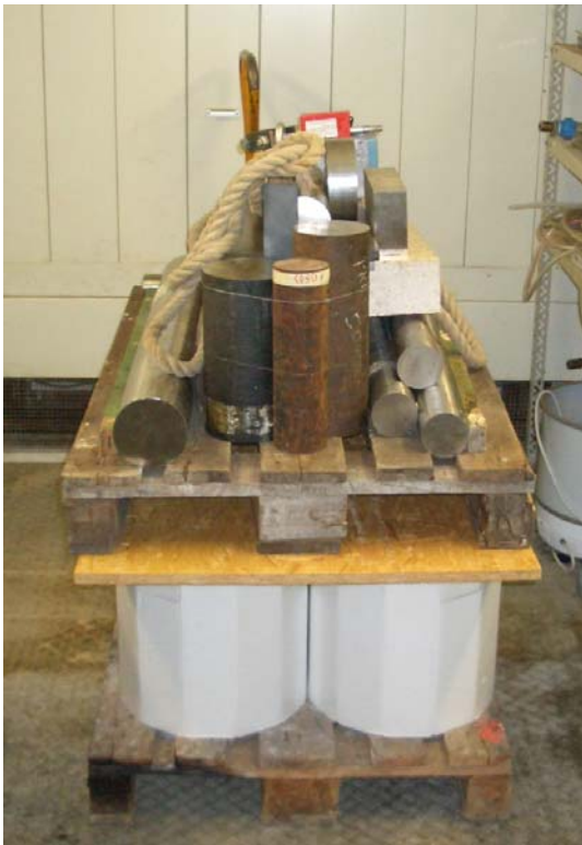
Abbildung 7: Eine Lage KeyKegs mit einer Beladung von 620 kg
